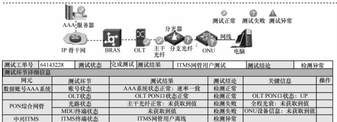
图5 宽带无法上网诊断结果
